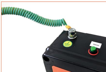
Figura 3: Instale o olhal do cabo de aterramento e aperte com a segunda porca M8.
