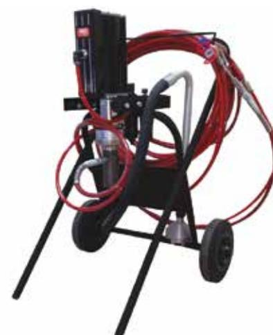
Aplicação de fluídos de alta viscosidade na maior proporção AIRLESS do mercado. Pistão e esfera em cromo duro, assentos e revestimento em tungstênio, proporciona ultra-suavidade nas operações. O sistema anti-congelamento das bombas PowrCoat foi projetado para fornecer resistência mecânica e suavidade de aplicação em longas jornadas, nos mais variados ambientes, seja no metal-mecânico, estaleiros, madeira ou cerâmico.
