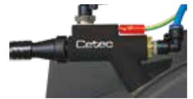
Câmara de sucção com proteção do ejetor. Ângulo de 30° proporciona menor atrito entre a tinta e as peças.
