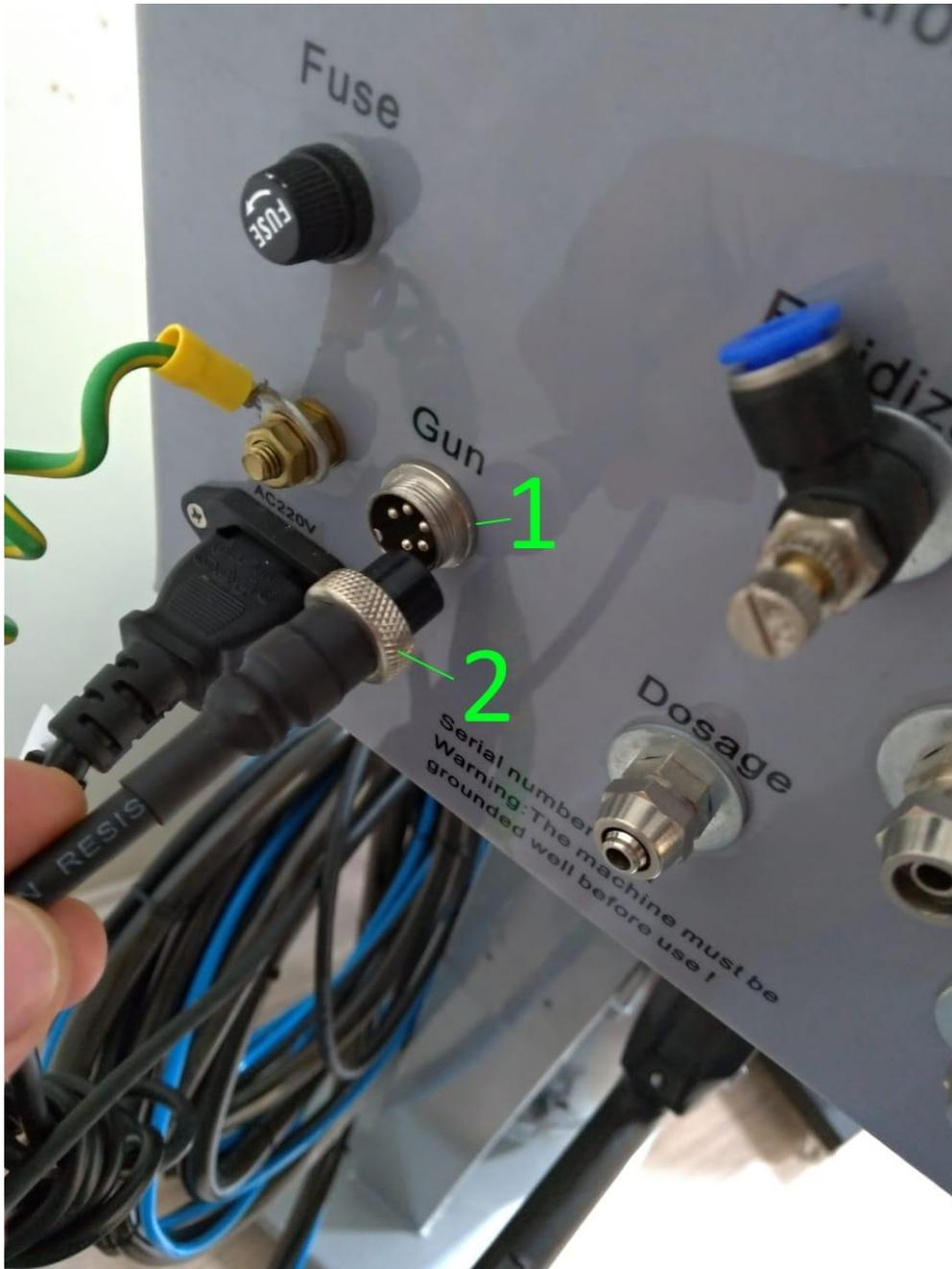
**Assegurar-se de que as conexões estão bem feitas, pois caso contrário poderá haver fuga de alta tensão, e conseqüentemente uma redução de rendimento na pintura, ou dano no equipamento.**
